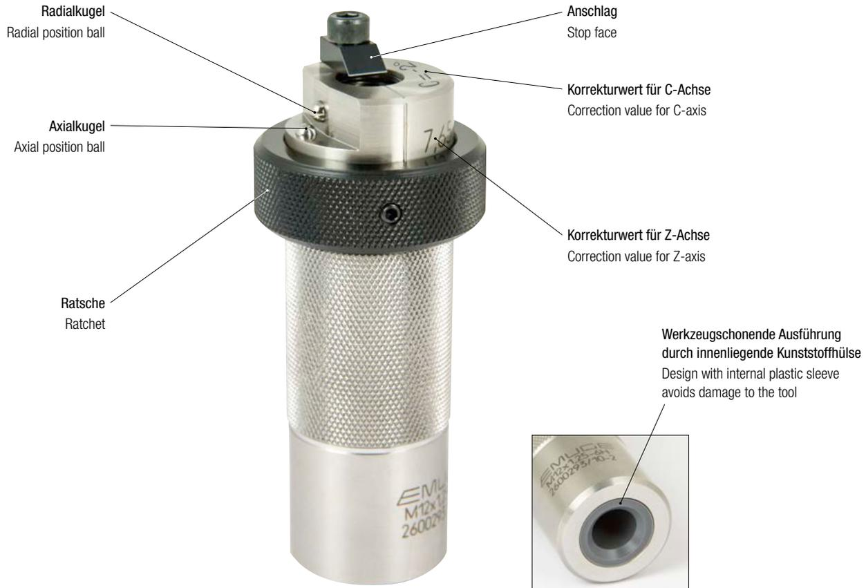
**Werkzeugschonende Ausführung durch innenliegende Kunststoffhülse**
